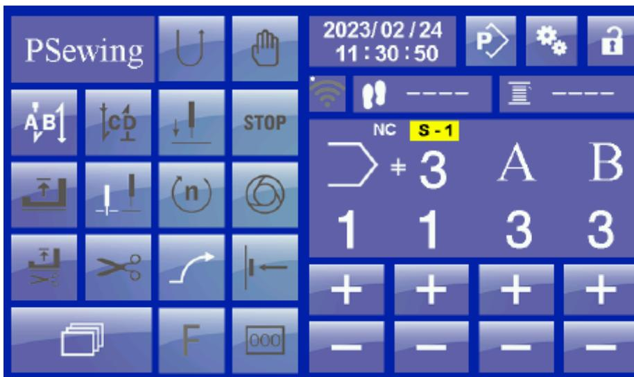
При программируемом шитье метод настройки начальной и конечной закрепки аналогичен методу настройки при свободном шитье. Отличительной особенностью этого шаблона является то, что в нём нельзя регулировать скорость или количество повторений для начальной и конечной закрепки. Если эти параметры нужно изменить, необходимо перейти в режим редактирования программы и выбрать соответствующий шаблон для редактирования.
