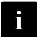
Клавиша системной информации. Длительное нажатие этой клавиши приведет к переходу в режим системной информации. Информационный режим включает в себя информацию о версии системного программного обеспечения для панели и блока управления, а также функцию обновления программного обеспечения для панели и блока управления. При переходе в этот режим система не может вернуться. Если вам нужно перейти в другие режимы, пожалуйста, выключите питание и перезагрузите устройство.
