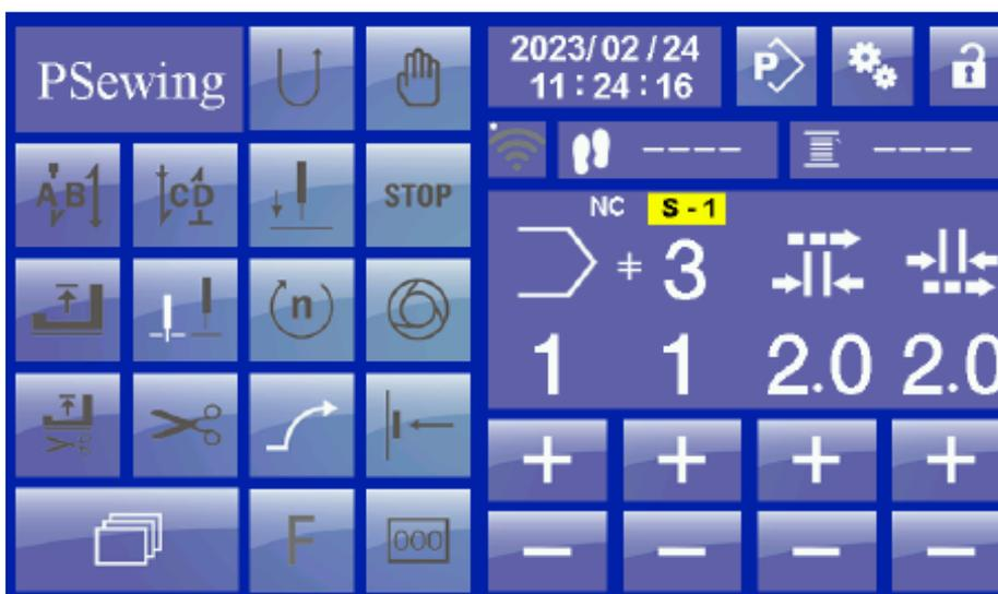
Как показано на рисунке выше, происходит переход ко второму сегментному интерфейсу, номер сегмента – это отображаемый 2-й сегмент, после **S -** номера и выбранного номера сегмента стоит та же цифра 2. Только в этом случае переход сегмента завершается успешно.
