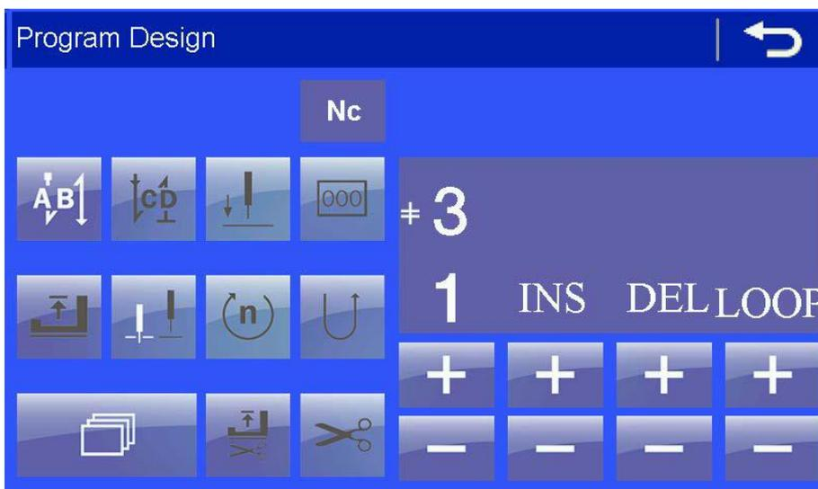
Нажмите “+”, “-” под “добавить сегмент”, “удалить сегмент”. Нажмите “+”, “-” под “циклическим шитьем”, чтобы настроить шаблон в качестве режима циклического шитья.
