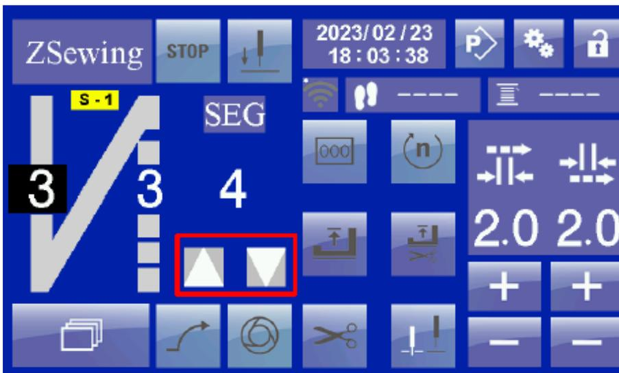
Как использовать стежки внахлест: участок А представляет собой переднюю часть шва, а участок В – заднюю часть шва. Число под символом "SEG" указывает на то, сколько в общей сложности надо прошить участков. Например, если SEG равно 1, это означает, что будет сшит только сегмент А, а если равно 2, это означает, что будет сшит сегмент АВ. 3 означает АВА. И так далее. Всего можно установить 8 сегментов. С помощью стрелок в красном поле можно увеличить или уменьшить количество сегментов.
